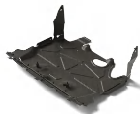
Защита двигателя из стали
